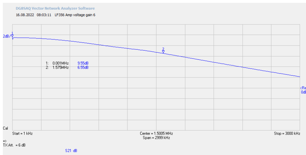
Abb. 5: 3dB-Bandbreite mit LF356, Spannungsverstärkung 6 (15,56dB).
