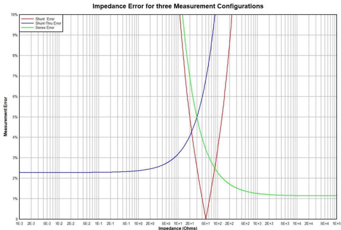
Abb. 0.2: Messfehler aus den Methoden (3), Shunt, rot, und (4), Series, grün. Quelle: [4].
