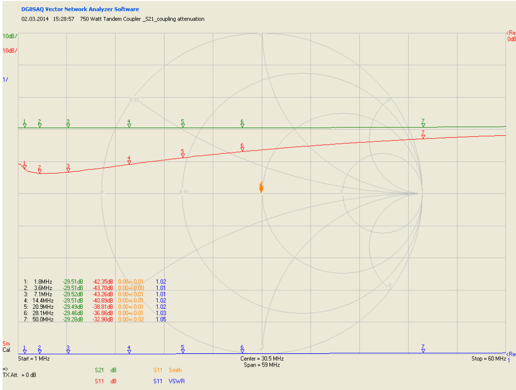
Abb. 4: Messergebnis zu Abb. 3, Kopplungsdämpfung vorlaufende Welle.
